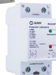
Protección Voltimétrica, microprocesada y autoalimentada, con display led de medición y configuración. protección por alta o baja tensión para línea monofásica de Un: 220Vca. Protección por <U: 160-210V; >U: 220-265V. Tiempo de actuación < 0,5s. Retardo a la conexión inicial y reposición 5-600s. Corriente nominal 32A (40A).. **Sencilla instalación y funcionamiento seguro.** 2 módulos DIN.
