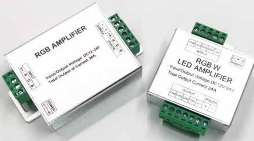
Su utilización es igual al mini amplificador pero con un mayor amperaje de salida, permitiendo alimentar mayor cantidad de metros de led. Permite controlar hasta 24 amper en tres o cuatro canales según el modelo. Recordar que para líneas continuas de led con dimmerización no se debe alimentar sólo de un extremo ya que la caída de tensión genera una baja en la iluminación a medida que aumentan los metros conectados. No conectar mas de 5 metros desde un solo extremo.
