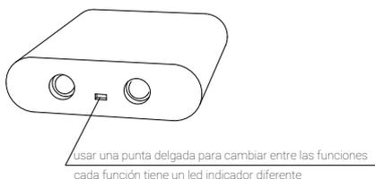
El sensor debe montarse dentro del armario o gabinete mientras que la cabeza del sensor debe quedar hacia el frente ajustando la distancia según el material de la puerta entre 10~100mm.
