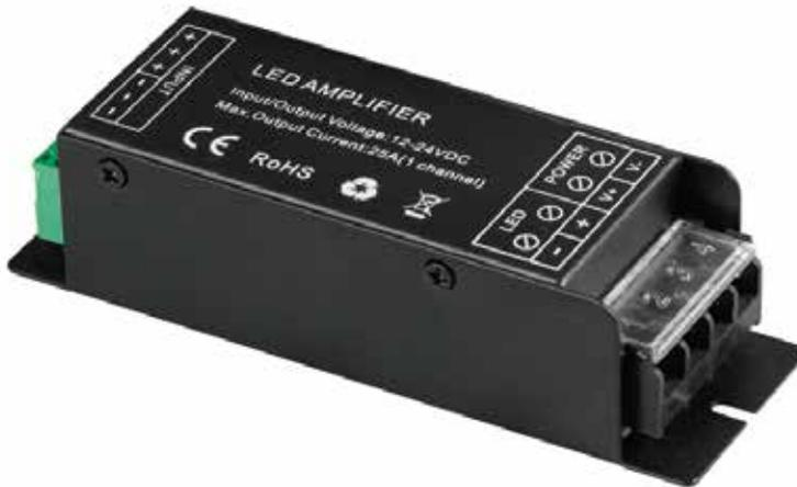
Su utilización es igual al mini amplificador pero con un mayor amperaje de salida, permitiendo alimentar mayor cantidad de tiras de led. Permite controlar hasta 25 amper en un canal monocromático. Recordar que para líneas continuas de led con dimmerización no se debe alimentar sólo de un extremo ya que la caída de tensión cae sobrepasando los 5 metros.
