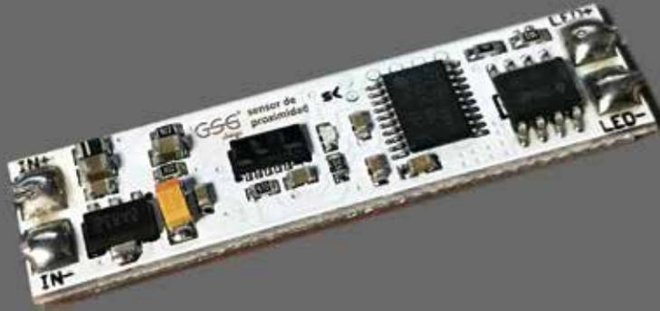
Interruptor de encendido/apagado por proximidad. Con un movimiento de mano sin contacto se enciende un módulo de led (en 12 o 24v). Es ideal para lugares donde no se tiene fácil acceso o donde no se quiera tener contacto directo con el perfil.
